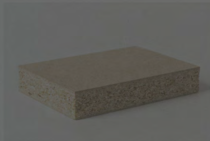
Hohlraumstruktur auf Basis aufgeschäumter Maisstärke
